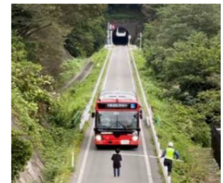
専用道への立入を想定した自動停車試験
